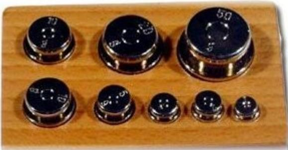
Massestücke können zu Wägesätzen zusammengesetzt werden wie das Bild zeigt. Die Massenangaben können addiert werden. Der abgebildete Wägesatz enthält folgende Massestücke:
