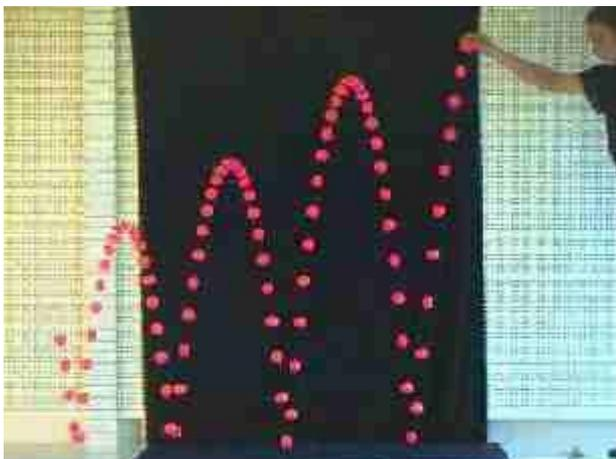
5. Als „Flummi“ bezeichnet man einen Ball aus Vollgummi. Die Bezeichnung kommt wahrscheinlich von „fliegendes Gummi“. Seine Eigenschaft besteht darin, dass ein Flummi seine potentielle Energie zu 50% wieder in kinetische Energie umwandeln kann. Deshalb bezeichnet man ihn auch als Springball.
